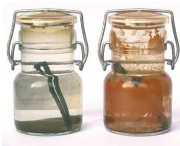
L'eau alcaline est par définition un anti oxidant : ici expérience du clou posé dans la baolyte comparé au clou posé dans l'eau du robinet (qui rouille evidemment : oxyde fer )
